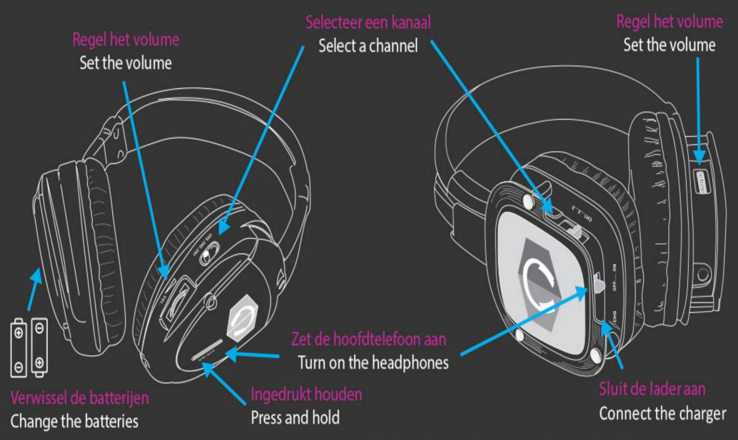
Minimaal 3uur opladen voor 8 uur gebruik
